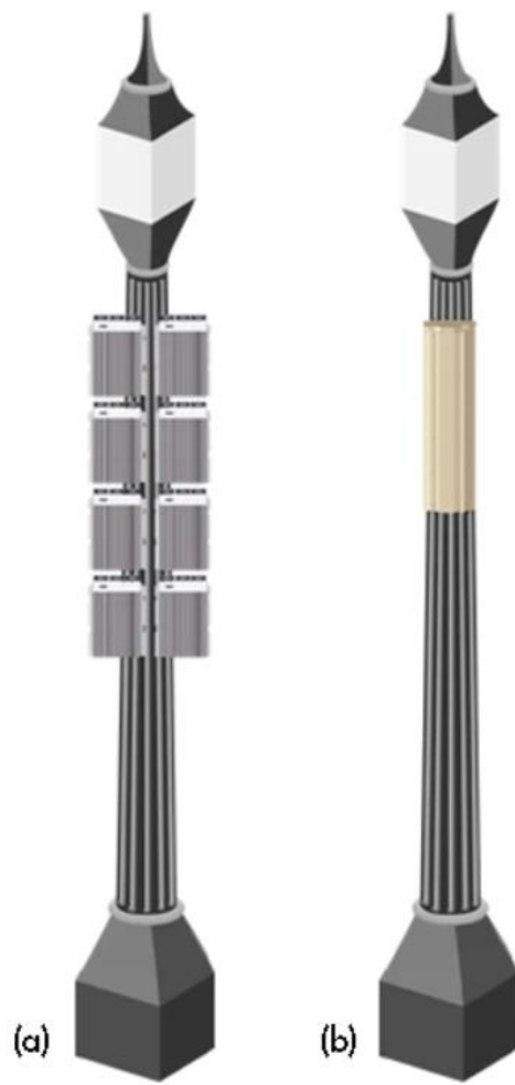
Εικόνα 2 Τοποθέτηση κεραίας σε φανοστάτη
