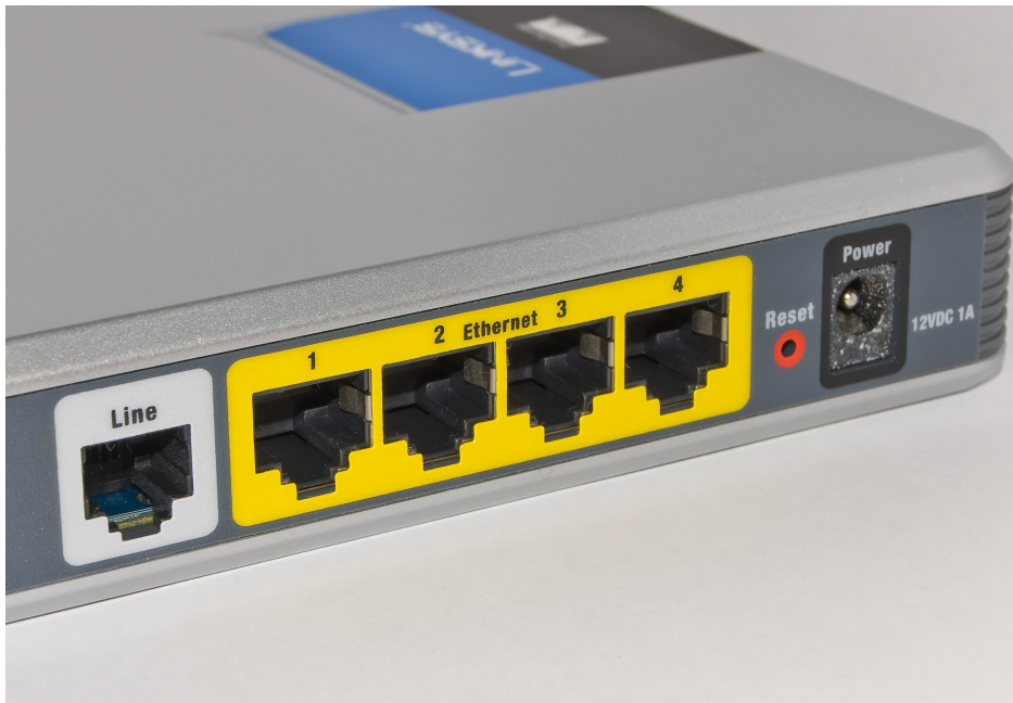
τυπικό router για χρήση σε σπίτι ή σε μικρό γραφείο. Στην εικόνα φαίνονται οι 4 θύρες ethernet και η θύρα ADSL
