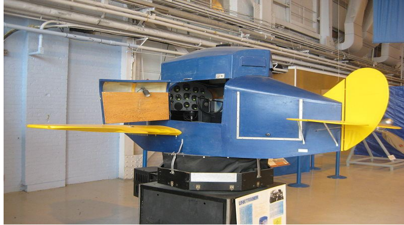
Εικόνα 2: Link Trainer διατηρημένο σε μουσείο του Καναδά [4].
