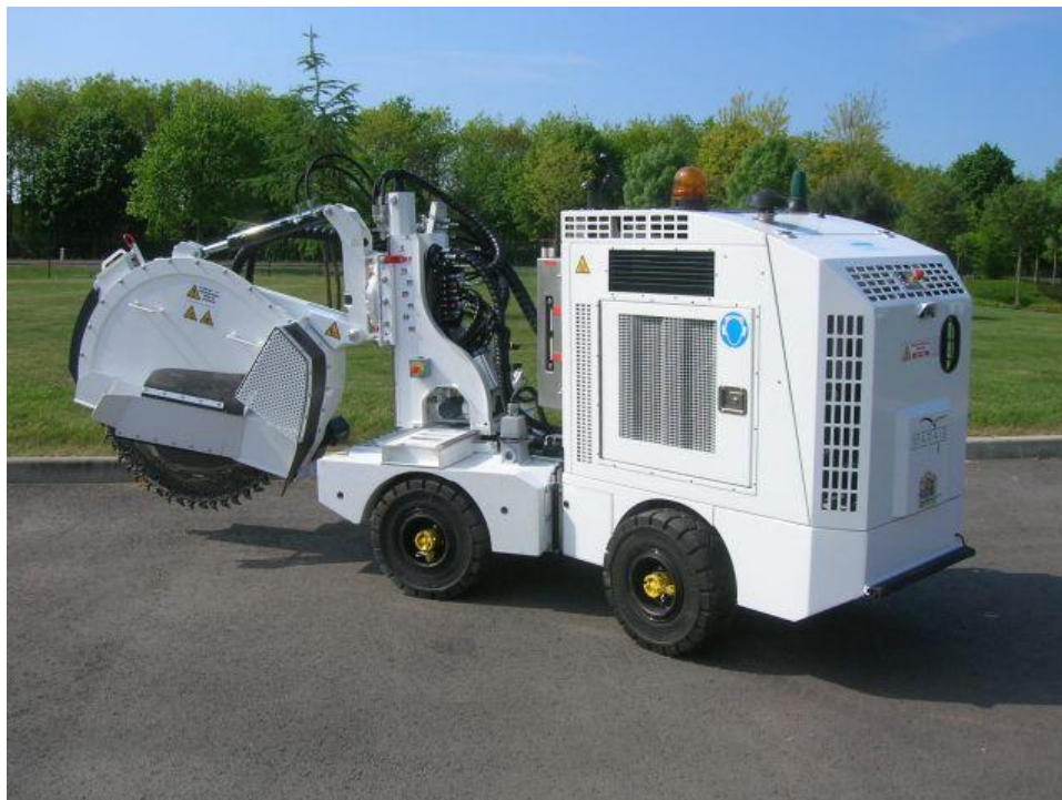
Εικόνα 23: Μηχάνημα για Micro-Trecher
