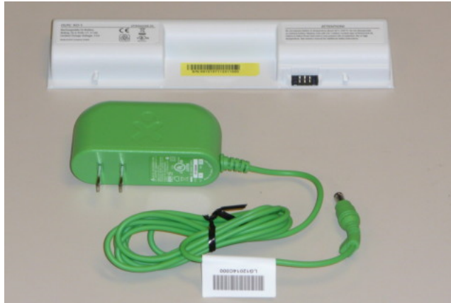
Σχήμα 4.2: Ο φορτιστής της μπαταρίας του OLPC
