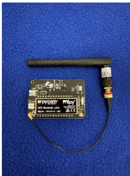
Εικόνα E20: Τελική εικόνα του End Device μετά την σύνδεση των επιμέρους υλικών
