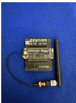
Εικόνα E16: Τελική εικόνα του NanoGateway μετά την σύνδεση των επιμέρους υλικών
