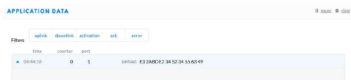
Εικόνα E33: Στιγμιότυπο επιτυχής αποστολής δεδομένων στο TTN από τη συσκευή node
